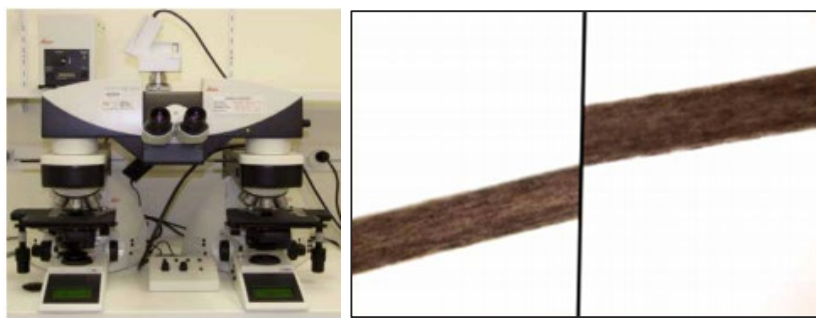
Снимка 106. Сравнителен микроскоп, позволяващ предметното стъкло с неизвестния косъм и това с известния да се изследват едно до друго, като космите бъдат сравнявани детайлно в едно и също зрително поле (Preedy V.R., 2012)
